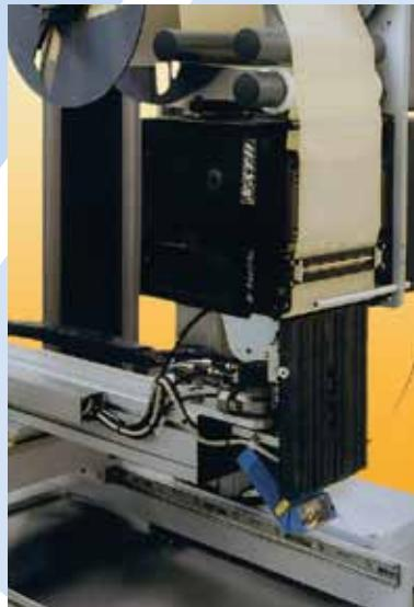
a 3 assi, con guide a sfere che permettono un veloce e preciso posizionamento delle etichette anche su pallet di dimensioni, forme e posizioni di arresto leggermente differenti.
