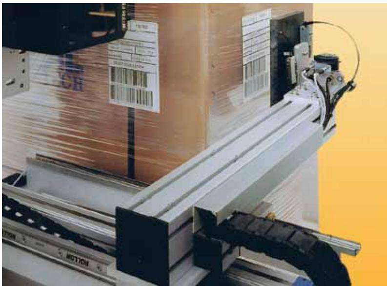
**Système d'impression/pose des étiquettes sur palettes**
