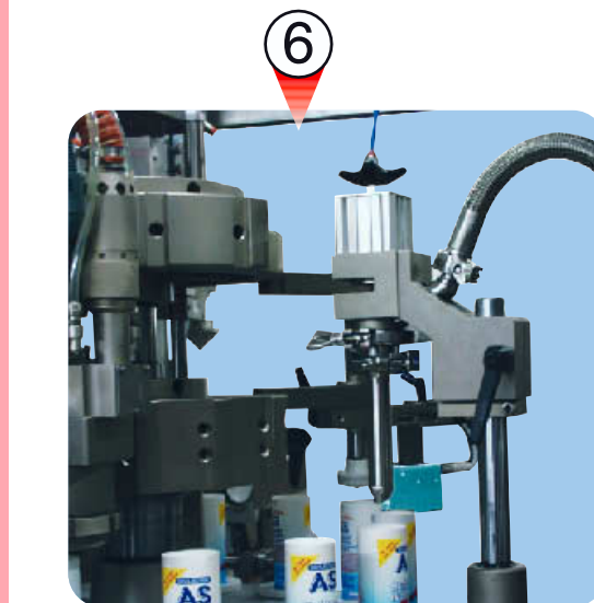
I NIETTORE DISCENDENTE A CORSA FISSA DI 70 mm UK DIVING FILLING NOZZLE FIX STROKE 70 mm
